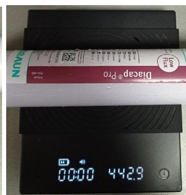
Obr. 39 – Dialyzační filtr použitý při měření a jeho parametry
