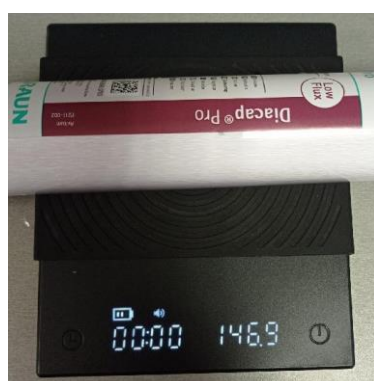
Obr. 39 – Dialyzační filtr použitý při měření a jeho parametry
